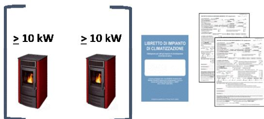
Due o più stufe che hanno una potenza termica utile complessiva  $\geq 5 \text{ kW}$  sono considerati come un impianto termico virtuale; occorre un apposito libretto di impianto dove saranno compilate tante schede 4.1 quanti sono i generatori presenti nello stesso ambiente.
