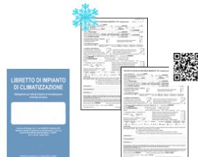
Quando le tubazioni o i canali connettono caldaie e macchine frigorifere/pompe di calore siamo in presenza di un unico impianto termico che deve essere descritto in un unico libretto, sarà compilata una scheda 4.1 per la caldaia e una scheda 4.4 per la macchina frigorifera o pompa di calore.
